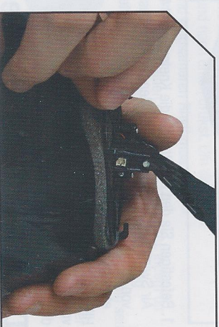
4. Verbinde das Kabel mit dem Motor, so wie du es hier siehst.
