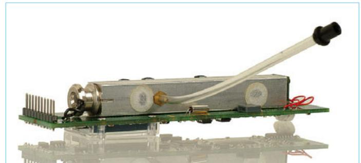
Bild 9. Das Infrarot-Modul ZG-02 von ZyAura. (Foto: ZyAura)
