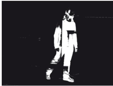
Bild 4. Ergebnis eines weiteren Schrittes: Ein Pixel erscheint hier weiß, wenn die Differenz der Grauwerte einen festgelegten Grenzwert übersteigt.
