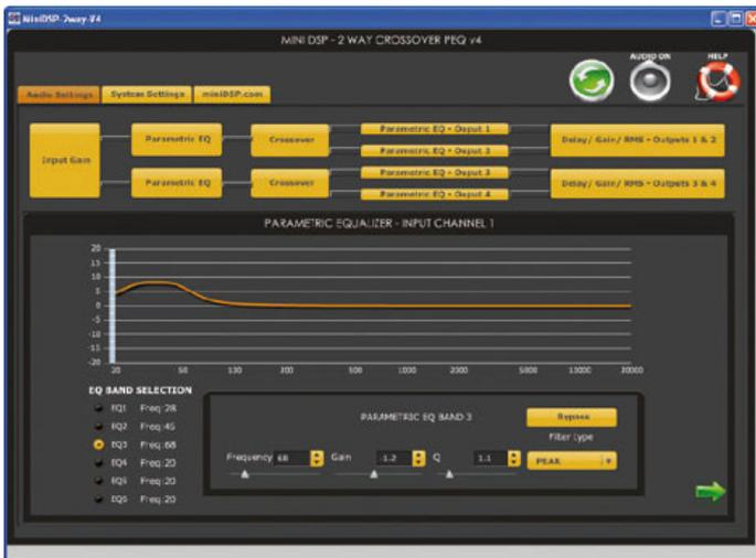
Bild 6. Die parametrischen Equalizer der Zweigweg-Frequenzweiche erlauben bis zu sechs Korrekturen (Frequenz, Signalniveau, Q-Faktor). Hier wurde eine leichte Bassanhebung realisiert.
