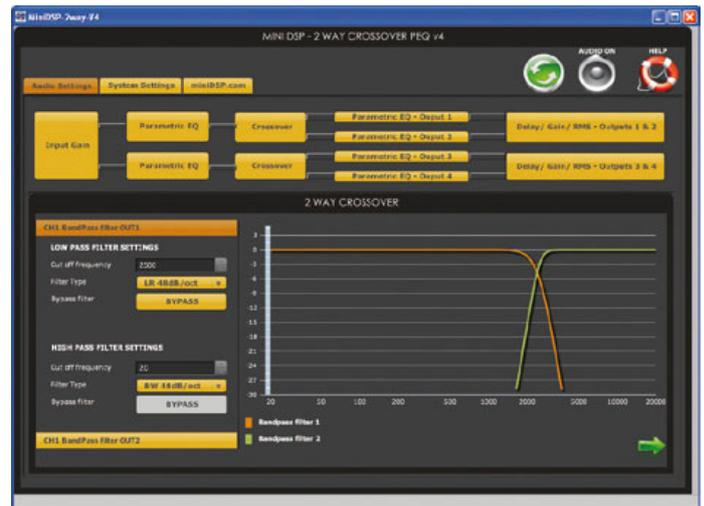
Bild 5. Hier wurden die Einstellungen der Frequenzweiche aufgerufen. Einstellbar sind der Filter-Typ, die Eckfrequenz und die Steilheit. Ferner ist eine Bandfilter-Konfiguration wählbar.
