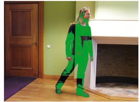
Bild 5. Die detektierten Pixel werden hier in das Originalbild eingespiegelt. Der rote Punkt in der Mitte markiert den Schwerpunkt.
