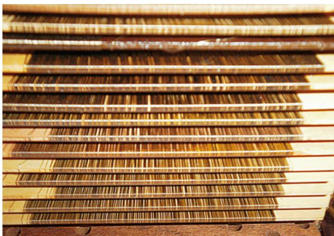
Die Vorwiderstände sind flach gewickelt, um die Induktivität klein zu halten, was dem Frequenzbereich zugute kommt. Sie sind genau abgeglichen. Mit 14 Widerständen für sechs Messbereiche und einer Verteilung der Last ist dafür gesorgt, dass an keinem Widerstand mehr als 1,5 W anfallen. Außerdem ist so die thermische Drift synchron. Dies und die gute Belüftung lassen erkennen, dass Genauigkeit hohe Priorität hatte.
