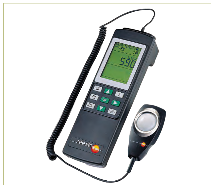
Bild 3. Luxmeter messen Beleuchtungsstärken über Raumwinkel von annähernd 180° (Foto: Testo).
