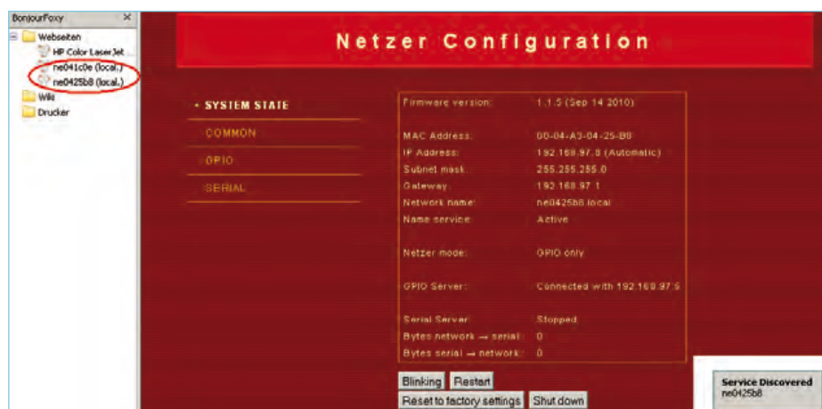
Bild 4. Das Browser-Plugin „Bonjour“ scant das Netz nach Anbietern (linker Bildteil). So bekommt man Zugang zum Netzer, ohne seine aktuelle IP-Adresse zu kennen.
