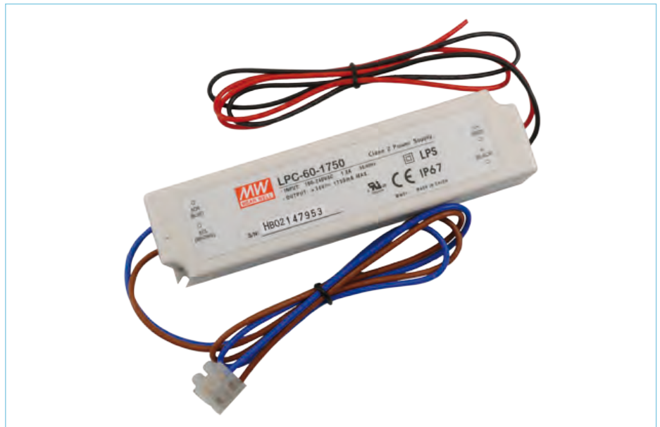
Bild 1. Dieses Schaltnetzteil von Mean Well arbeitet als Stromquelle mit 1,75 A und passt daher perfekt für die 50-W-LED.
