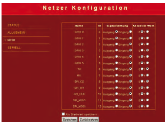
Bild 7. Die Radiobuttons zeigen den Zustand an den Pins.
