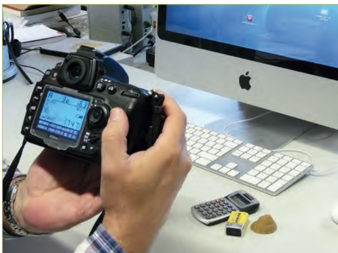
Bild 4. Zum näherungsweisen Bestimmen von Beleuchtungsstärken genügt eine digitale Kamera, zusammen mit Tabelle 2.
