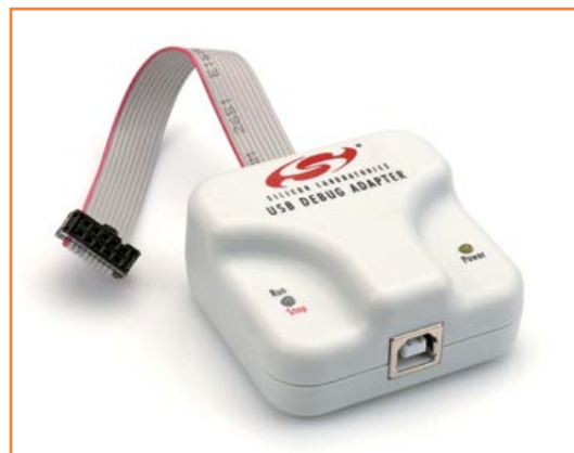
Bild 8. In den leeren Mikrocontroller muss der Bootloader geflasht werden, mit Hilfe dieses Moduls.
