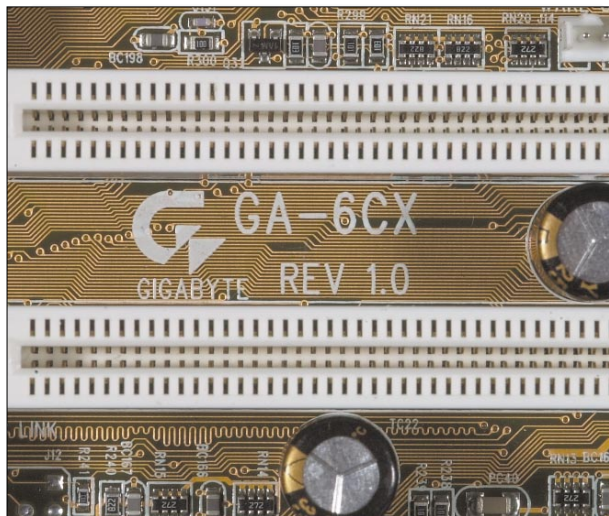
DIE GENAUE BEZEICHNUNG Ihres Mainboards bringen Sie im Zweifelsfall über den Aufdruck am Mainboard in Erfahrung.
