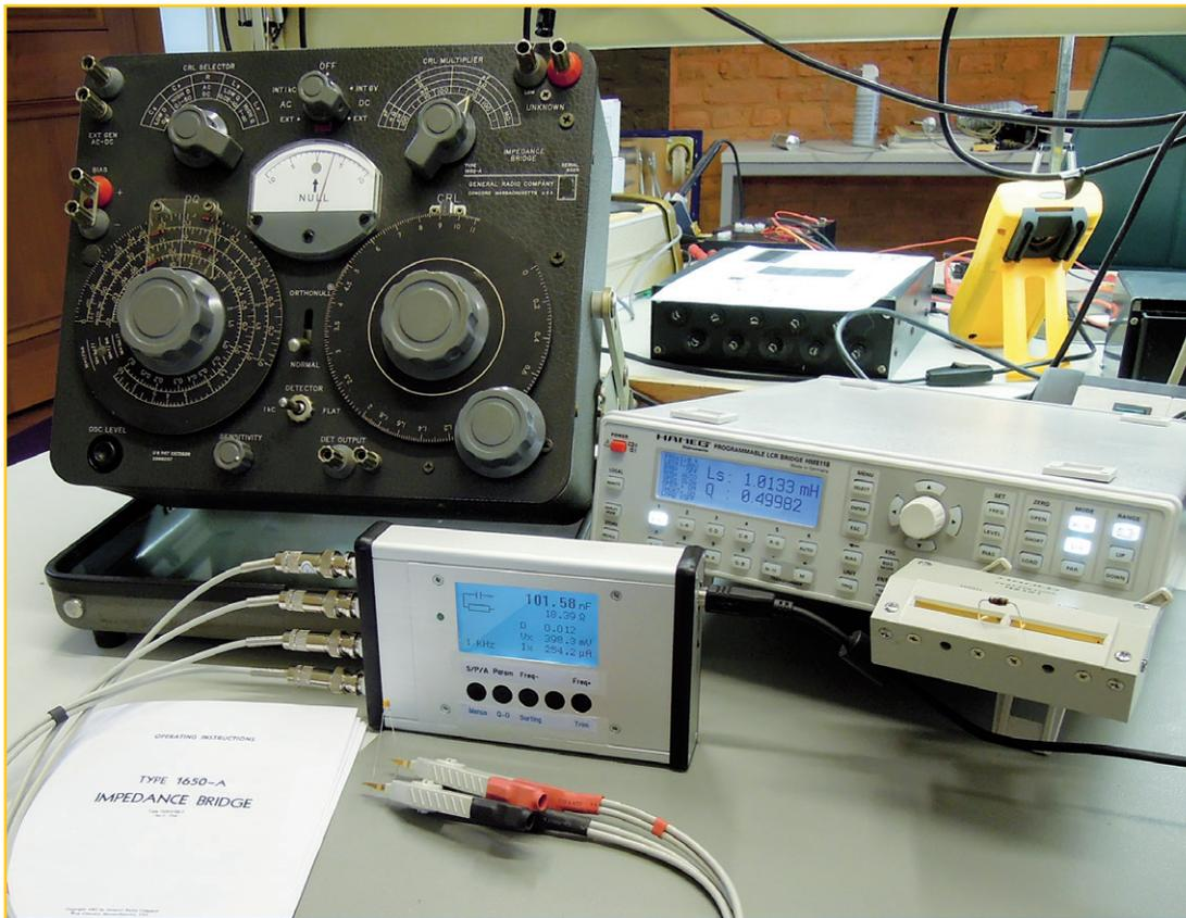
Under Test) in die Testhalterung (Hameg HZ181) und schon erscheinen die gewünschten Eigenschaften des Bauteils auf dem blauen LCD. Zeitbedarf 40 Sekunden vom Beginn bis zum Ergebnis, ganz ohne Blick in das Handbuch. Mehrere Bauteile messen? Für das Auswechseln des DUT sind 3 Sekunden fällig und die Wahl des richtigen Messbereichs kostet vielleicht noch 2 Sekunden, sodass 5 Sekunden pro Bauteil zusammen kommen.
