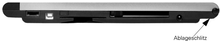
Geräterückseite mit Ablageschlitz für den Zeigestift
