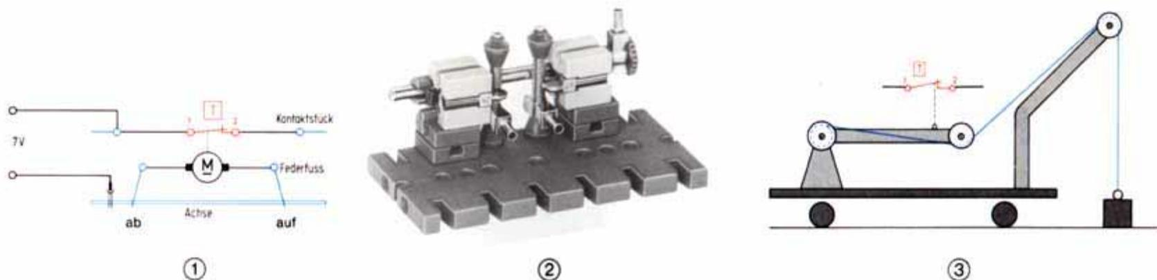
■ Elektrisch funktioniert die Sicherung ganz einfach: Wir bauen z. B. in die Verbindung der beiden Schließergegenstücke der Wechsler den Öffnerkontakt 1-2 des ft-Tasters nach Bild 1-36 ein. Wird dieser bei Überlast betätigt, bekommt der Motor keinen »Saft« mehr, weil sein Stromkreis unterbrochen wird, und er bleibt sofort stehen.
