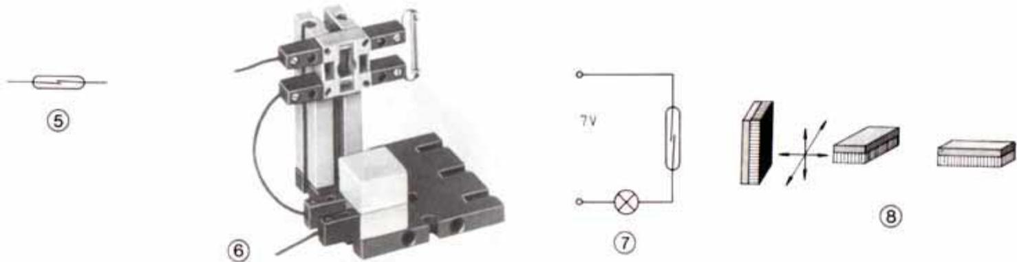
■ Zunächst bauen wir die einfache Versuchsanordnung 6-57 auf. Im Bild ist auch die praktische Verdrahtung des Reedkontaktes mit Hilfe der Leuchtsteinfassung zu sehen.
