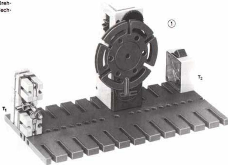
Drehrichtung davon abhängt, von welcher Seite her der Motor vom Strom durchflossen wird. Und genau das können wir mit Hilfe der trickreichen Wechslerschaltung steuern.
