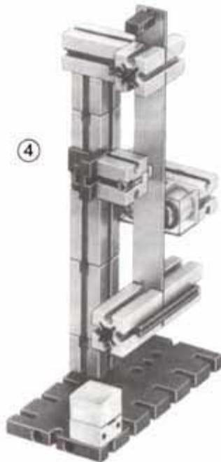
Der E-Magnet kann in allen Richtungen verschoben werden. Die beste Stellung für das einwandfreie Schwingen der Feder kann man nur durch Probieren herausfinden.
