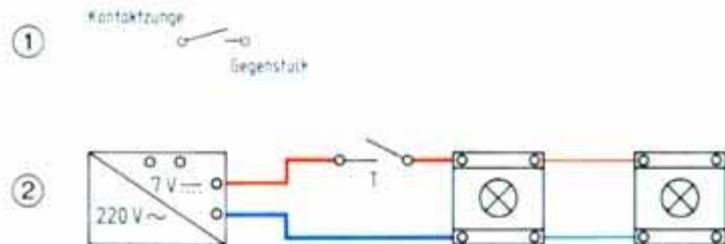
Zur Lösung der Aufgabe brauchen wir ein Gerät, mit dem man einen Stromkreis schlagartig schließen bzw. unterbrechen kann – einen *Taster*. Das Schaltzeichen dafür zeigt Bild 1-10.
