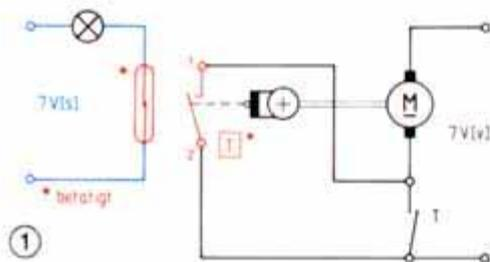
■ Die eben erprobte Schaltung 7-57 ist unverändert im Schaltplan 1-61 mit blauer Farbe eingetragen. Die »Zeitschaltung« mit Motor, Nockenscheibe und parallel geschalteten Tastern kennen wir auch schon.
