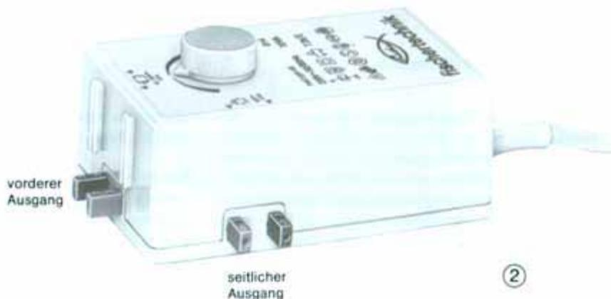
Das Netzgerät besitzt zwei »Ausgänge«: So nennen wir kurz die vorderen und seitlichen Buchsenpaare des Gerätes. Beide Ausgänge führen Gleichspannung. Diese kann am vorderen Ausgang mit dem Drehknopf umgepolt und zwischen 0 und etwa 7 V eingestellt werden. Die Spannung am seitlichen Ausgang hat dagegen einen unveränderbaren Wert von rund 7 V. (Die früheren Netzgeräte mit Wechselspannung von etwa 7 V am seitlichen Ausgang können auch verwendet werden.)
