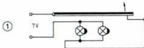
ist, um so höher muß die »Raumtemperatur« sein, bei welcher der Thermokontakt geöffnet wird. Zugleich dient der Bi-Streifen praktischerweise auch als »Zimmerdecke«.
