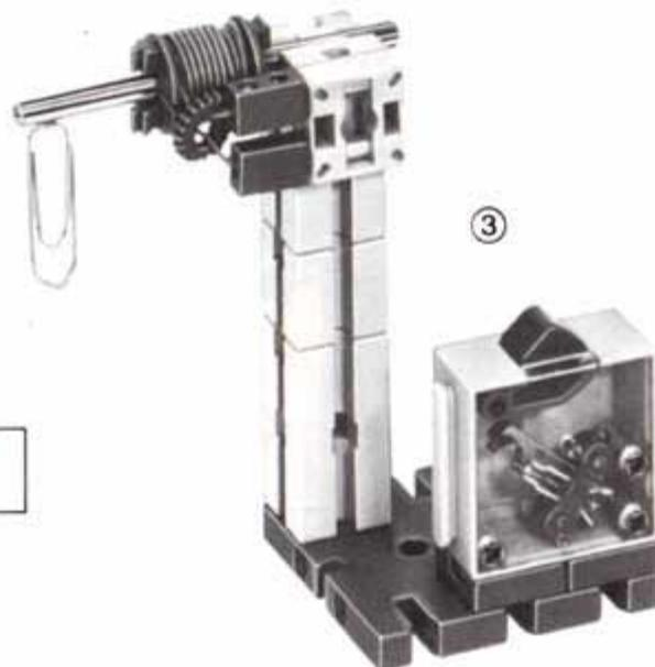
■ Wir brauchen jetzt das 1 Meter lange, grüne Kabel: Es wird nach Bild 1–62 fest um die Seiltrommel gewickelt; die beiden Enden werden durch die Riegelscheibe gesteckt, mit den beiden noch übrigen Steckern versehen und diese in die Leuchtsteinfassung gesteckt. Durch diese Spule stecken wir eine Achse-50 als Eisenkern und montieren das Ganze nach Bild 3–62 an der Halterung.
