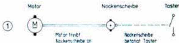
■ Den zum Blinken nötigen Eintaster bauen wir diesmal aus zwei Federfüßen mit Klemmbuchsen zusammen. Er wird automatisch von zwei »Nocken« betätigt. Das sind hier die Winkelsteine auf der motorgetriebenen Drehscheibe im Bild 5–15. Für das einwandfreie Funktionieren des Tasters ist es in diesem Fall vorteilhaft, wenn beide Tasterteile federn. Bild 5–15 zeigt den fertigen Tasteraufbau. Zwischen beiden Federfüßen sollte ein Luftspalt von rund 1 mm bleiben.
