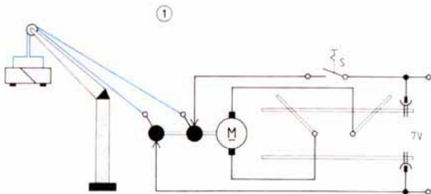
■ Der Strom wird mit dem E-Magneten mit Hilfe unseres Schleifringes über die im Schaltplan 1-71 blau eingetragenen Verbindungsleitungen zugeführt. Wir benutzen dazu eine Doppellitze aus dem Motorkasten. Sie dient gleichzeitig als Lastseil für den Hubmagneten (Bilder 4-72 und 5-73). In der
