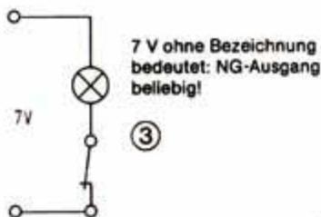
Bild 1-18 zeigt das Schaltzeichen eines Austasters: Im Ruhezustand ist der »Tasterkontakt« geschlossen. Das wird durch das Häkchen am Gegenstück besonders deutlich.
