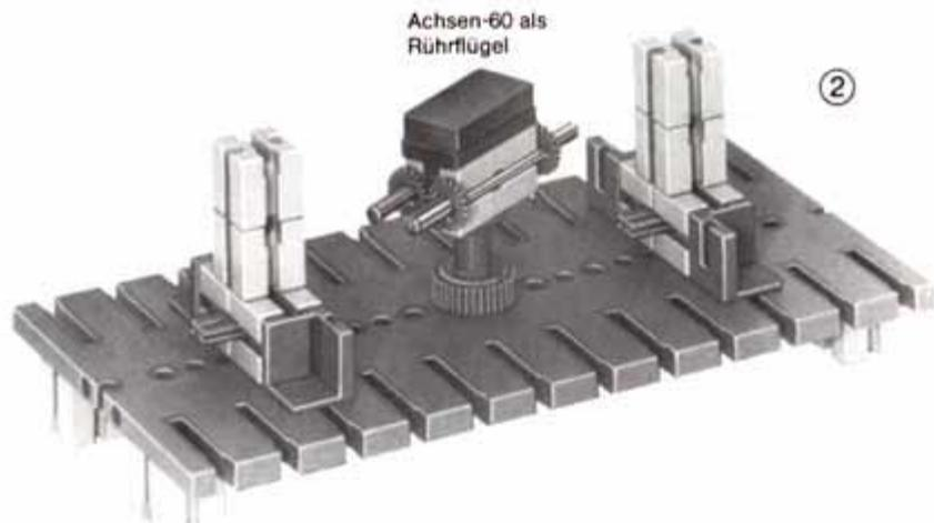
■ Bild 1-52 zeigt, wie der Magnet auf der Welle mit den Rührflügeln mit Hilfe einer Seilrolle befestigt wird. Diese Achse-50 muß nach Bild 2-52 unterhalb der Grundplatte mit einer Klemmrolle gesichert werden; sonst würde sie vom Magneten der Antriebswelle (Bild 5-53) gegen die Bauplatten gezogen, die den »Gefäßdeckel« darstellen sollen (Bild 3-53).
