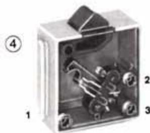
Bild 2-21 zeigt zwei Bauformen eines »Wechslers«: Es sind die schon erprobten Austaster 2-18, erweitert um einen *Federkontakt* als Schließergegenstück.
