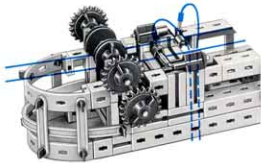
63.4 Stromzuführung über Fahrseile
