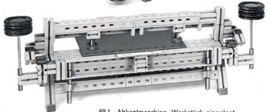
69.1 Abkantmaschine, Werkstück eingelegt Biegewange unten
