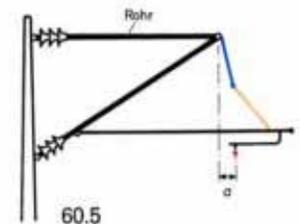
Unser Mastmodell (Bild 61.1) stellt einen Nachspannmast dar, wie er in Abständen von 1500 m aufgestellt ist und zur Nachspannung des Fahrdrahtes und eventuell des Tragseiles dient. Das Prinzip der Nachspannvorrichtung zeigt Bild 62.1.
