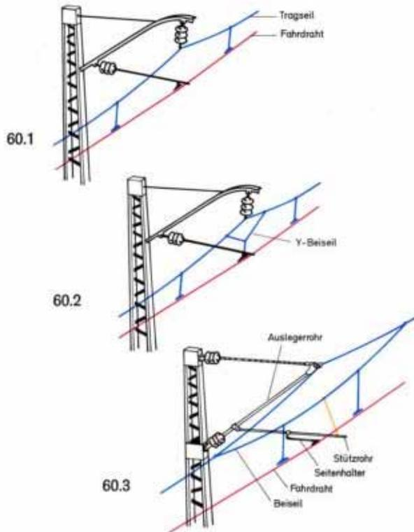
Der Seitenhalter kann bei allen diesen Konstruktionen elastisch nach oben ausweichen, wenn der Stromabnehmer unter der Fahrdrähtklemme vorbeischieft. Die Entwicklung der Fahrleitungen für höhere Geschwindigkeiten zielt also auf gleichmäßige Höhenlage des Fahrdrahtes und richtige Stützpunktselastizität ab. Ferner gibt es besondere windfeste Systeme, da die Mastentfernung nicht nur von der Schleifstückbreite des Stromabnehmers, sondern auch vom
