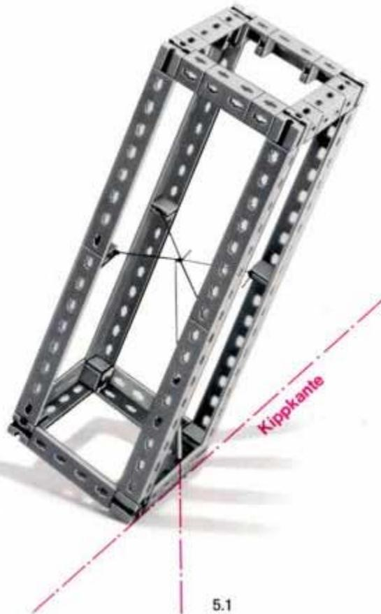
Eine besondere Bedeutung hat die Standfestigkeit bei Kranen. Bei unserem Kranmodell nach Bild 6.1 und 7.4 erzeugen die Gewichtskräfte der Last  $F_L$  und das Eigengewicht des Auslegers  $F_E$  an den Hebelarmen  $h_L$  bzw.  $h_E$  das Kippmoment  $M_K$ .
