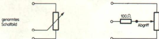
Ein Potentiometer kann als Spannungsteiler oder als veränderlicher Widerstand benutzt werden. In letzterem Fall schließt man nur an 2 Klemmen an.
