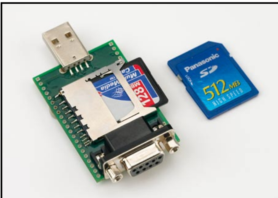
Bild 3. Auf der Platinen-Oberseite befinden sich nur drei Bauteile: Der USB-Stecker, die RS232-Buchse und der MMC/SD-Kartenhalter.
