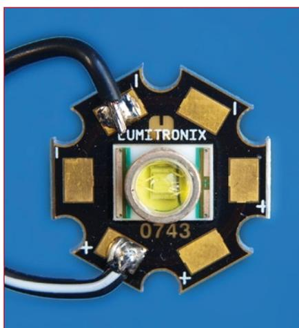
Bild 1. Die vom Autor für Experimente verwendete 3-W-LED von Cree ist ein besonders ästhetisches Stück Elektronik.
