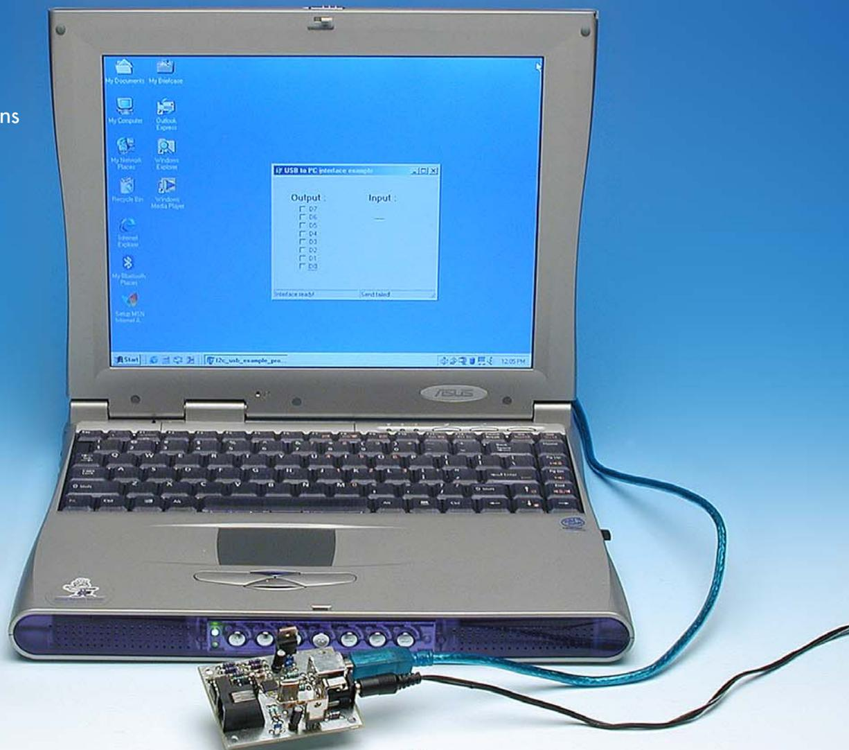
Seit der Einführung des I<sup>2</sup>C-Bus von Philips in den achtziger Jahren wird dieser Bus auch gern für die Verbindung selbst entwickelter Hardware mit dem PC eingesetzt. Die Anpassung übernimmt meist eine einfache Interface-Schaltung, die vom PC-Parallelport gesteuert wird. Weil das nicht mehr ganz zeitgemäß ist, haben wir ein I<sup>2</sup>C-Interface für den USB-Port entwickelt.
