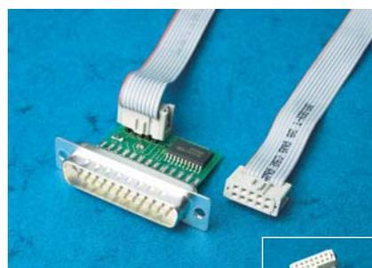
**Mit einer Hand voll Bauteilen kann der Parallel-Port des PC das Flash-ROM des Atmel-Prozessors befüllen, ohne dass dieser aus dem B-Modul ausgebaut werden muss.**
