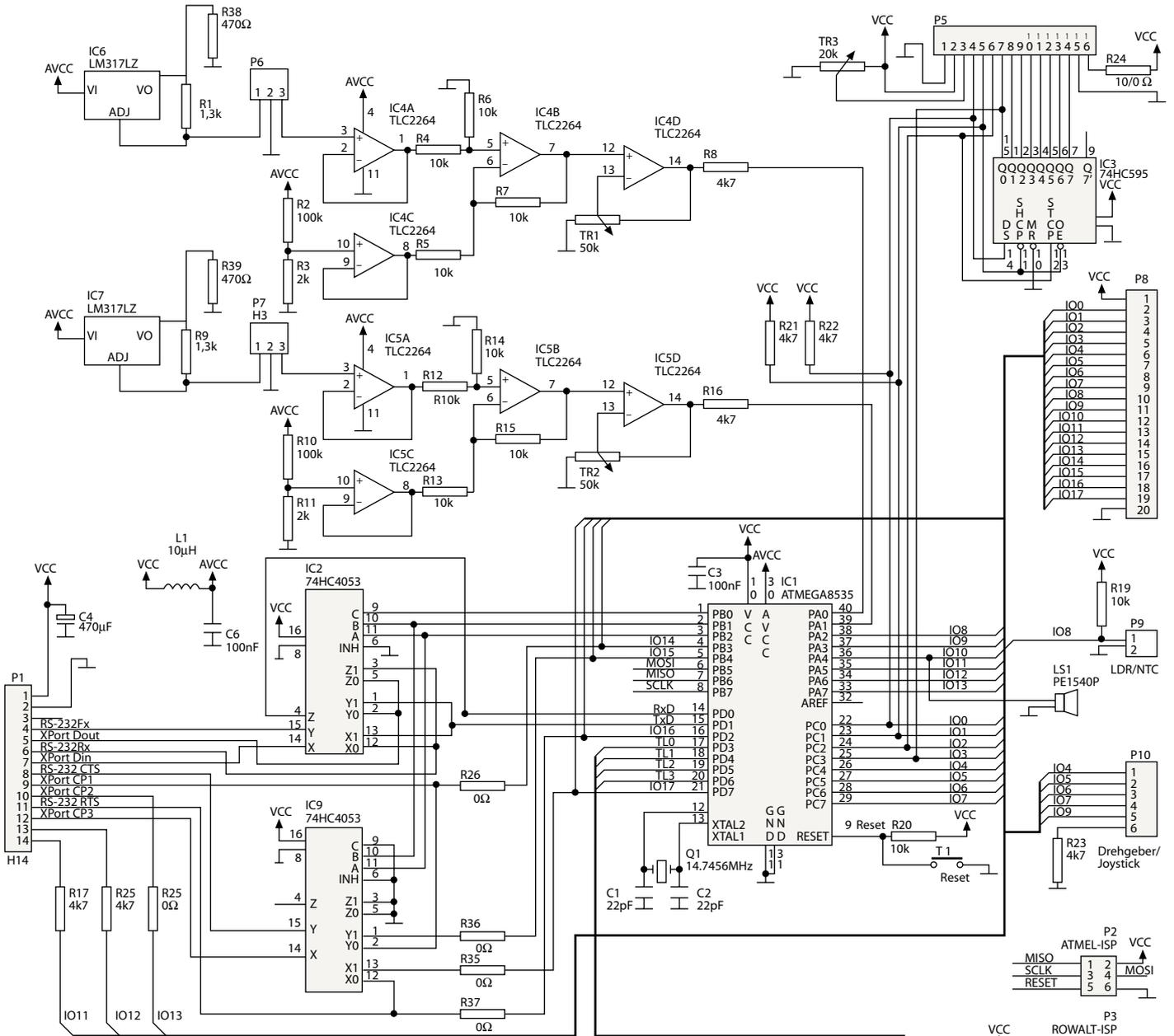
**Der 8-Bit-Mikrocontroller von Atmel besitzt einen integrierten 10-Bit-Analog-Digital-Umsetzer mit acht Kanälen. Zwei davon nutzen wir, um ein Ethernet-Thermometer zu realisieren.**
