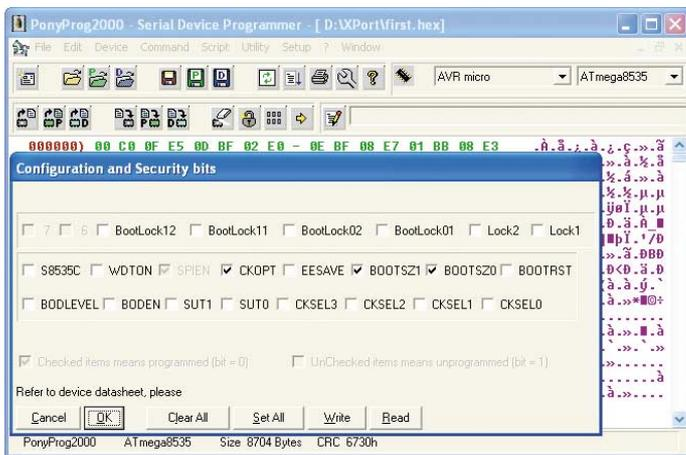
**Beim Programmtransfer in den Controller ist es extrem wichtig, auf die korrekte Einstellung der Fuse-Bits zu achten, weil er sonst den ISP-Port zur Programmierung deaktiviert.**
