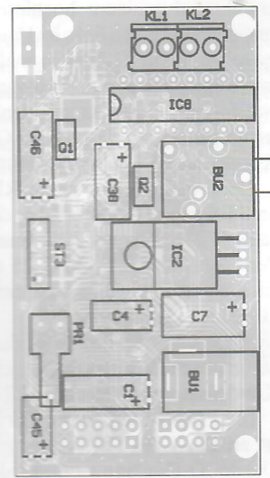
Vollständig bestückte Basisplatine (links die SMD-Seite und rechts die Seite der konventionellen Bauteile mit den zugehörigen Bestückungsplänen)
