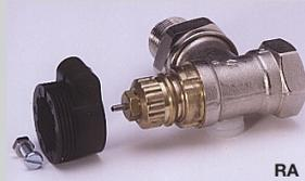
Die Adapter für die Ventile Typ RAV und RA sind nach dem Aufrasten auf den Ventilkörper mit der beiliegenden Schraube und Mutter zu befestigen. Auf Ventile vom Typ RAV ist außerdem noch die zylindrische Verlängerung auf den Ventilstift zu setzen.
