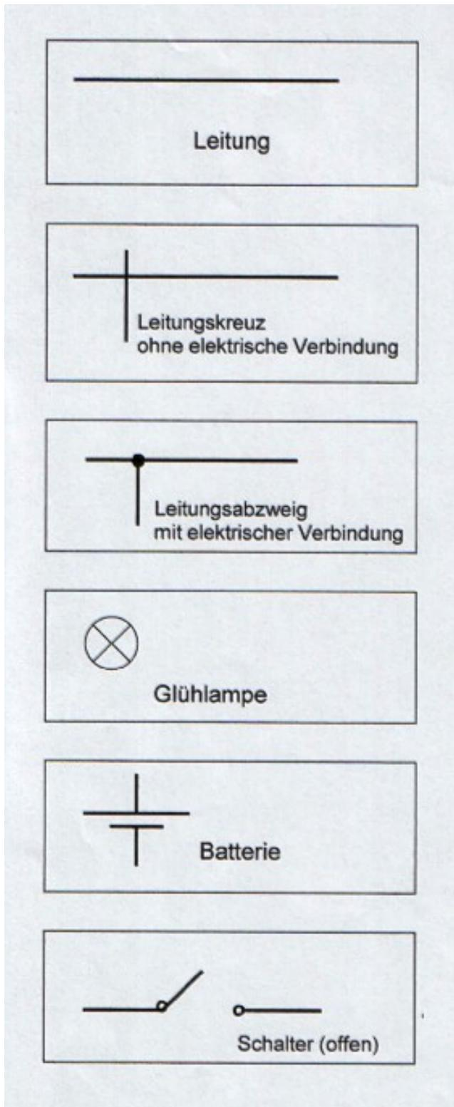
Wenn du einen Stromkreis zeichnen möchtest, musst du die Batterie, die Glühlampe oder den Schalter nicht genau abzeichnen. Für diese einzelnen Bestandteile gibt es Zeichen oder Symbole, die das Zeichnen einer Schaltskizze sehr einfach machen.
