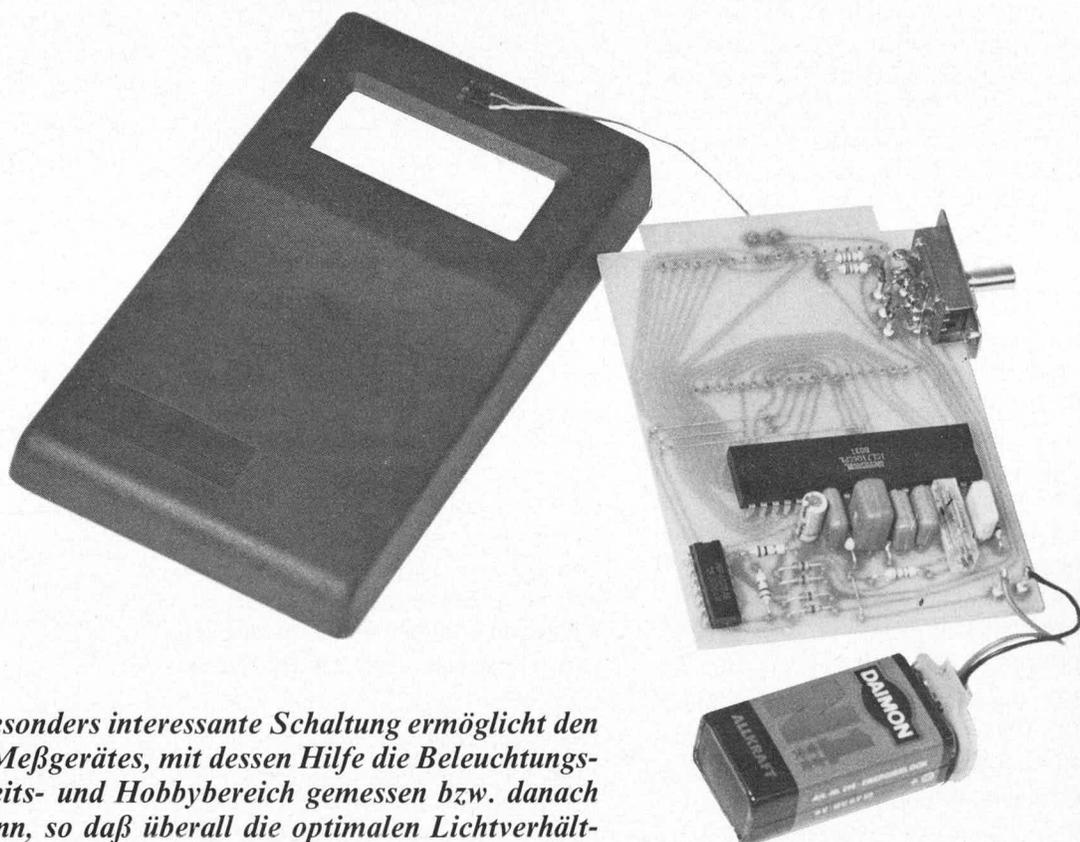
*Die hier vorgestellte, besonders interessante Schaltung ermöglicht den Aufbau eines digitalen Meßgerätes, mit dessen Hilfe die Beleuchtungsstärke im Wohn-, Arbeits- und Hobbybereich gemessen bzw. danach eingerichtet werden kann, so daß überall die optimalen Lichtverhältnisse vorliegen.*
