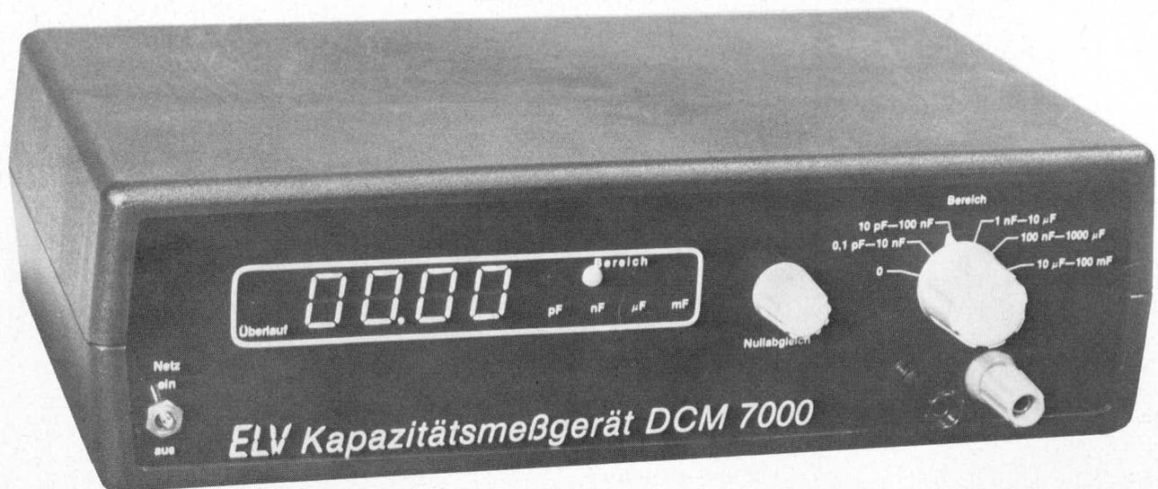
**Die hier vorgestellte, einfach nachzurüstende Schaltung, synchronisiert den Meßzyklus des DCM 7000 mit der Netzfrequenz, wodurch sich im unteren Meßbereich eine deutliche Verbesserung der Anzeige ergibt.**
