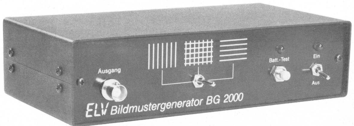
***Mit dieser zuverlässig arbeitenden und doch einfach aufzubauenden Schaltung können sowohl vertikale und horizontale Linien als auch ein Gittermuster auf dem Fernsehschirm erzeugt werden. Hierdurch wird es möglich, die Konvergenz und Bildlinearität zu überprüfen und nachzustellen.***
