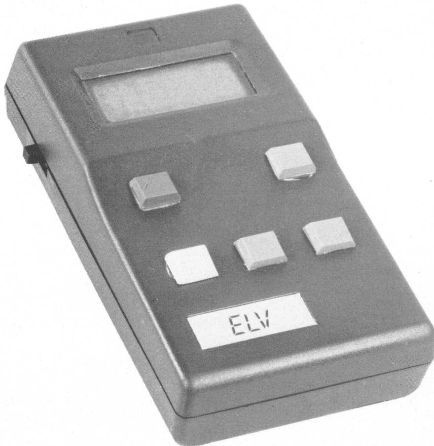
**Mit dieser, in einem formschönen Gehäuse untergebrachten elektronischen Stoppuhr können Zeiten bis zu 1000 Sek. bei einer Auslösung von 0,1 Sek. gemessen werden. Die Steuerung (Auslösung) kann sowohl über Taster als auch fernsteuerbar, z. B. über Lichtschranken, Klatschschalter usw., erfolgen.**
