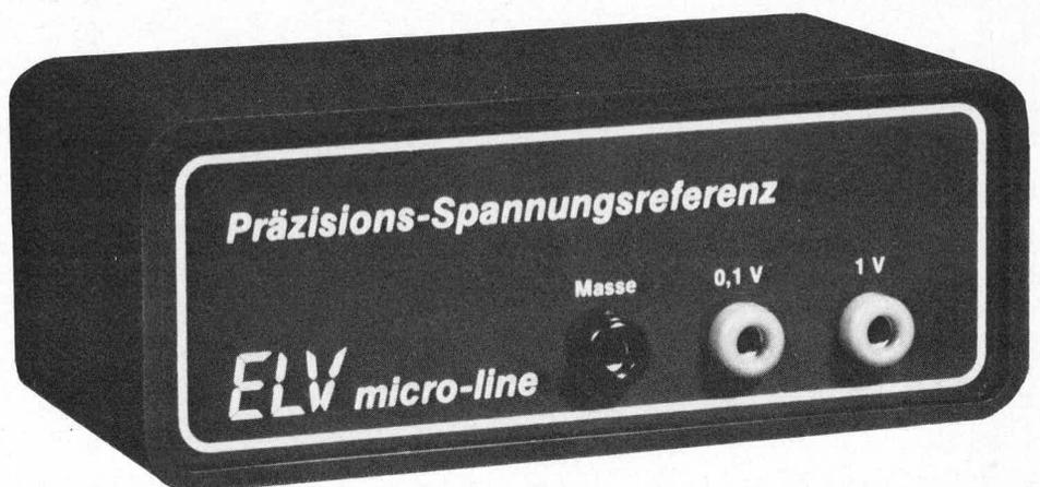
*Gute Genauigkeit, Langzeitkonstanz und geringe Temperaturdrift bei günstigem Preis-/Leistungsverhältnis, zeichnet diese Präzisions-Spannungsreferenz aus, die zur Kalibrierung von hochwertigen Digital-Multimetern geeignet ist.*
