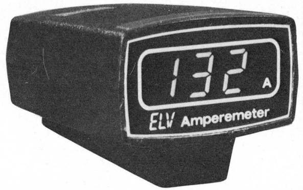
*Mit einem Meßbereichsumfang von  $\pm 200$  A stellt dieser Strommesser eine wertvolle Ergänzung der Instrumentierung im Kfz dar. Hinsichtlich der Meßwertaufnahme wurde im ELV-Labor eine besonders einfache, jedoch wirkungsvolle und genaue Möglichkeit entwickelt. Das Ergebnis wird digital auf einem 3stelligen LED-Display angezeigt.*
