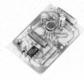
Wir stellen Ihnen daher in diesem Artikel die Schaltung eines echten Effektivwert-Gleichrichters vor, die zur Nachrüstung der meisten gebräuchlichen elektronischen Digital-Multimeter geeignet ist. Eine Eingangsspannung im Bereich von 0 bis 200 mV (Effektivwert) wird in eine entsprechende Gleichspannung von ebenfalls 0 bis 200 mV umgesetzt. Die genauen technischen Daten können der Tabelle I entnommen werden.
