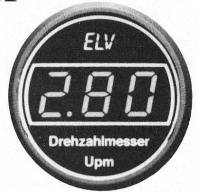
*Dieser 3stellige, digitale Kfz-Drehzahlmesser zeichnet sich durch hohe Auflösung (10 Upm), schnelle Meßfolge (3 Messungen pro Sekunde) sowie gute Genauigkeit (ca. 1 %) und Stabilität aus. Er ist für 3-, 4-, 5-, 6- und 8-Zylinder-Motoren bis zu einer Drehzahl von 10 000 Upm geeignet.*
