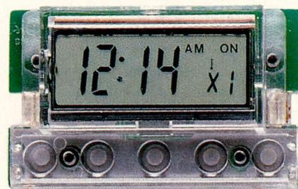
Ansicht des betriebsfertigen Prozessor-Moduls mit LC-Display
