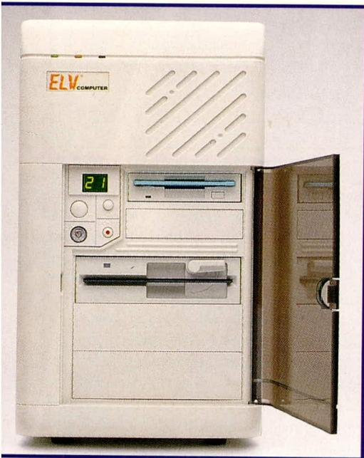
**Bild 2: Frontansicht mit Bedienteil des ELV-Computers**
