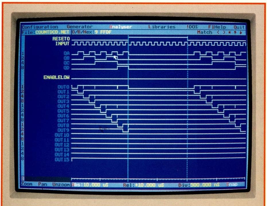
Die Simulation eines 4-Bit-Zählers mit Decoder
