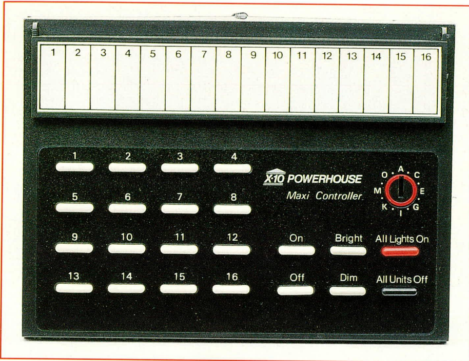
Bild 3: Bedienpanel der 16-Kanal-Steuerzentrale
