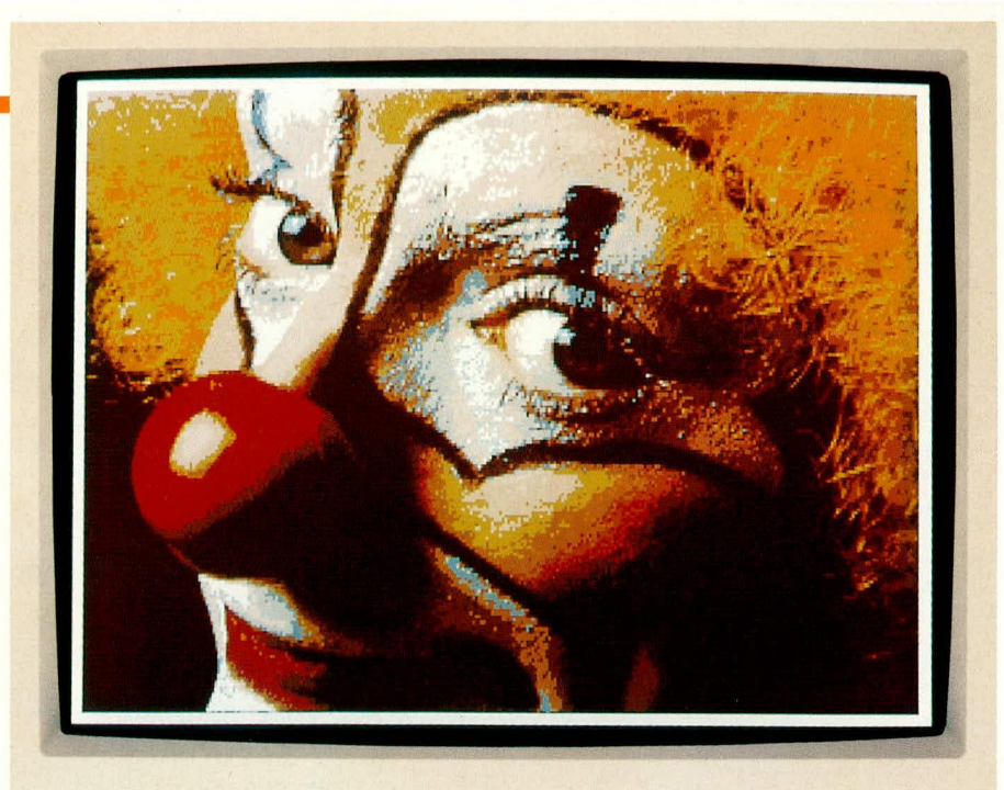
Bild 2: Transformation von 320 x 200 Bildpunkten und 256 Farben auf 640 x 480 Bildpunkte und 16 Farben
