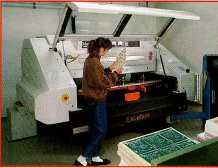
**Bild 15: 4 Spindel-Bohrvollautomat der Firma Excellon**
