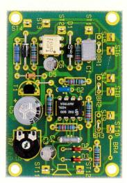
Ansicht der fertig aufgebauten Leiterplatte der Gong-Schaltung
