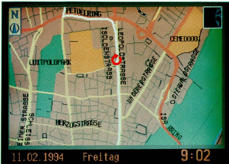
Bild 6: Das CARIN-System ermöglicht die Navigation auch direkt per elektronischer Karte auf dem Bordmonitor. Dabei wird der aktuelle Fahrzeugstandort stets mit angezeigt.
