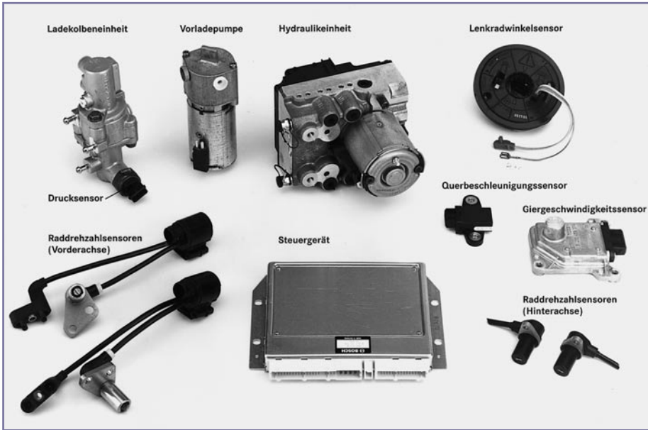
Bild 3: Die Komponenten der Fahrdynamikregelung von Mercedes-Benz zeigen den hohen Aufwand an verschiedenen Sensoren (Foto: Mercedes-Benz)
