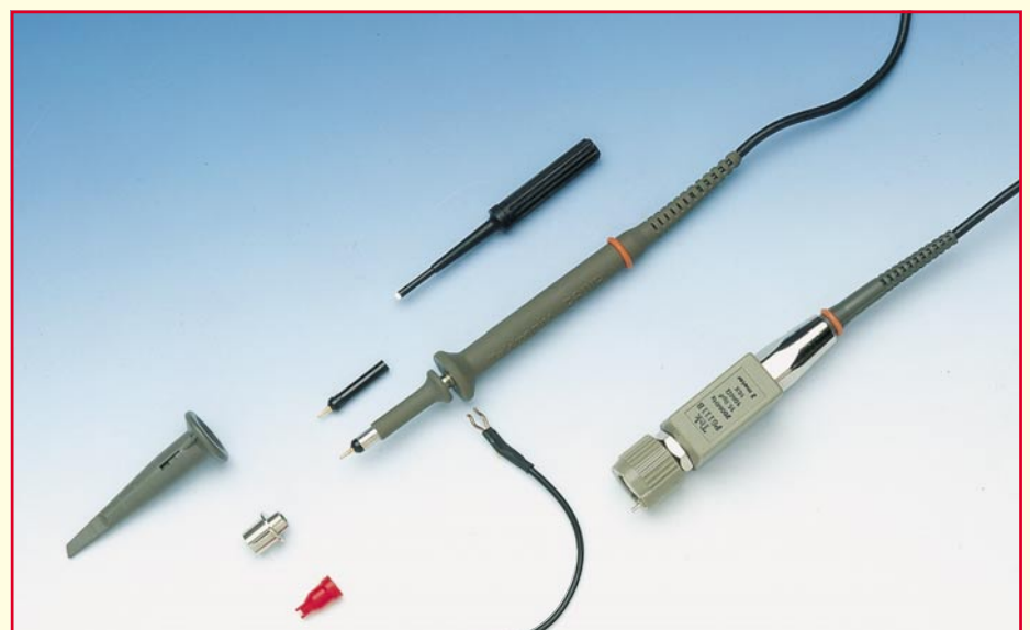
Bild 25: Typisches Beispiel für einen passiven Tastkopf und eine Auswahl an Zubehör für diesen Tastkopf
