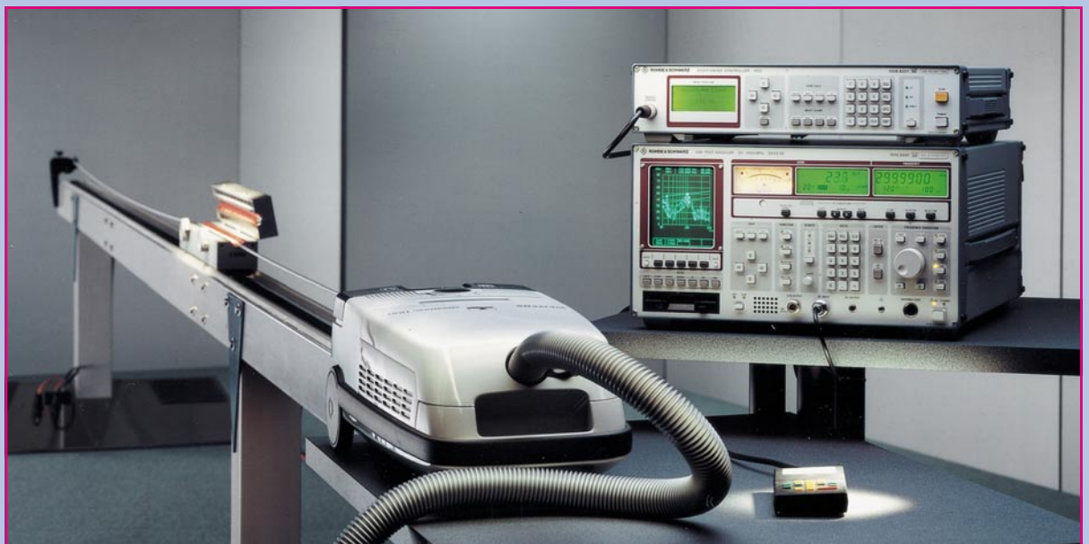
Bild 5: Meßplatz zur Funkstörleistungsmessung
