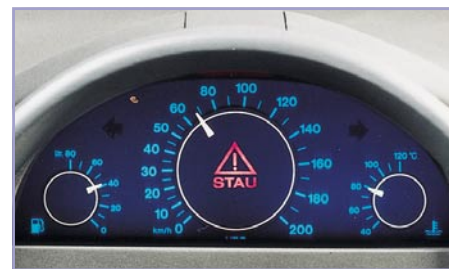
Bild 3: Eine interessante Variante analoger Anzeigen ist die LC-Anzeige mit „elektronischen“ Zeigern (Foto: VDO).
