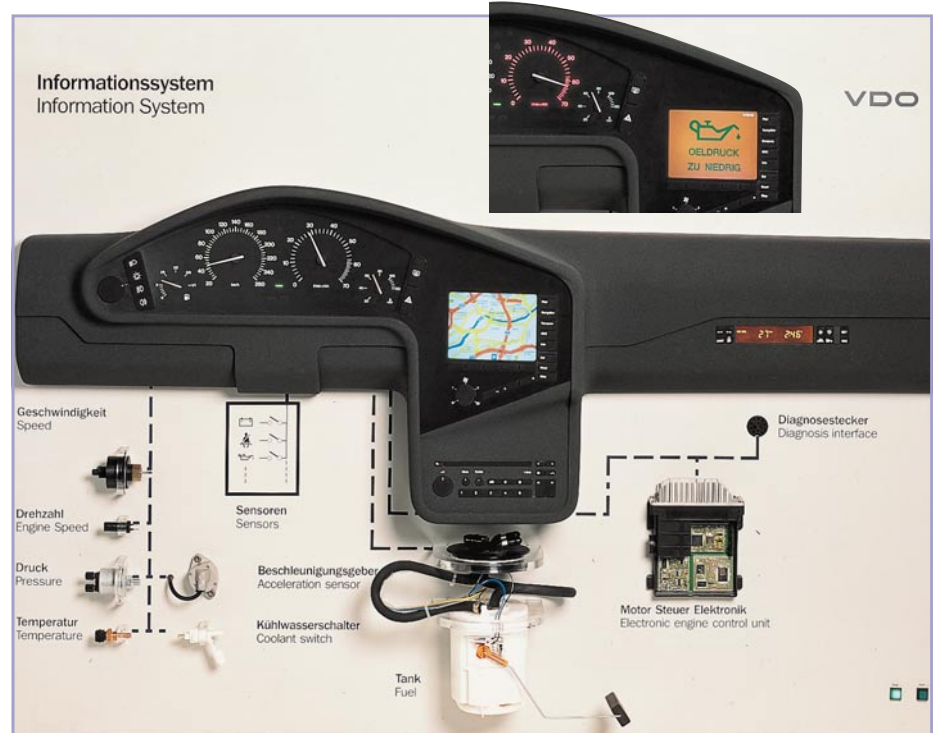
Bild 6: Derzeit Stand der Technik: Anzeige verschiedener Informationen auf abgesetzten Displays (Bild: VDO).
