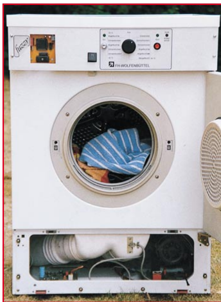
Hardware-Realisation des Fuzzy-Reglers am Beispiel des Fachhochschul-Wäschetrockners
