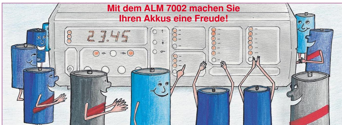
**Entladen:** Durch einmalige Betätigung der Taste „Funktion“ wird auf „Entladen“ umgeschaltet. In dieser Position nimmt das ALM 7002 eine Entladung des angeschlossenen Akkus bis zur jeweiligen Entladeschlussspannung vor, unter Berücksichtigung der vorgewählten Daten (Entladestrom = Ladestrom). Den Abschluß des Entladevorgangs kennzeichnet das Blinken der LED „Entladen“.
