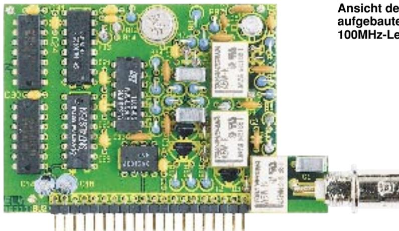
Ansicht der fertig aufgebauten DC-100MHz-Leiterplatte
