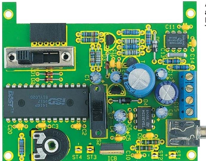
Ansicht der fertig aufgebauten Basisplatine des Türgongs
