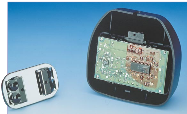
Bild 1: Sensoren erfüllen heute komplexe Aufgaben in der Steuerung von Fahrzeugfunktionen. Zur Gruppe der Komfortsensoren zählt der Regensensor der neuen E-Klasse von Mercedes-Benz (Bild: Mercedes-Benz)
