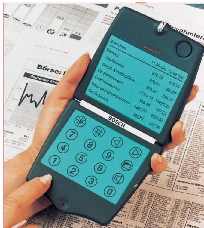
Bild 1: Designstudie von Bosch Telecom für ein mobiles Audio-/Video-Terminal zur Verarbeitung der DAB-Zusatzdienste (Foto: Bosch).
