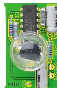
Aufgebaute Platine des IR-Vorverstärkers mit zugehörigem Bestückungsplan
