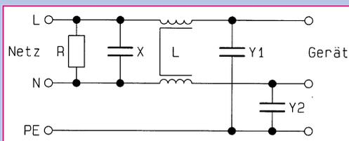
**Bild 10: Schaltbild des einfachen Netz-Entstörfilters**
