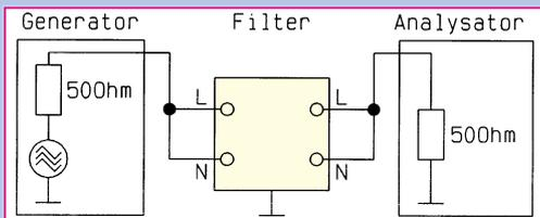
**Bild 9: Meßverfahren zur Dämpfungsbestimmung bei asymmetrischen Störspannungen**
