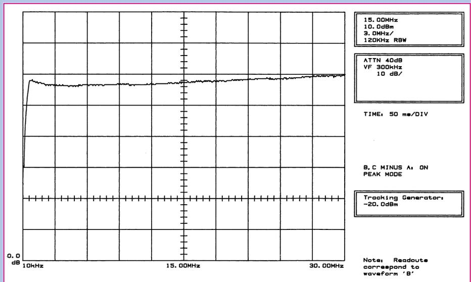
Filterverläufe für symmetrische und für asymmetrische Störungen. Es ergibt sich eine gute Störunterdrückung von ca. 70 dB für die symmetrischen und 60dB für die asymmetrischen Störungen.
