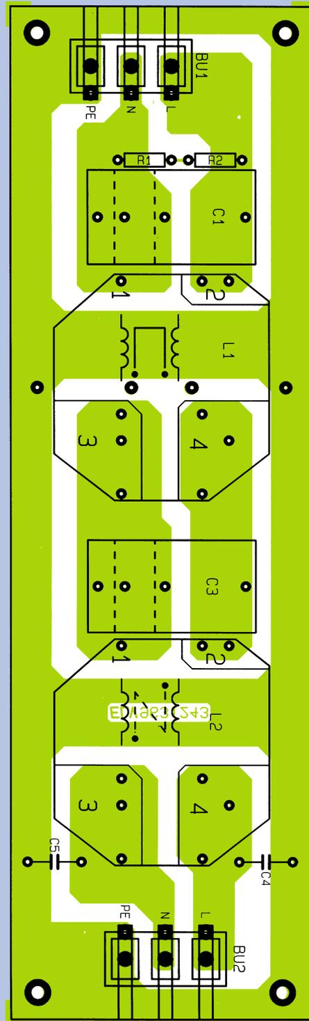
Ansicht des fertig aufgebauten einfachen Netz-Entstörfilters mit zugehörigem Bestückungsplan.
