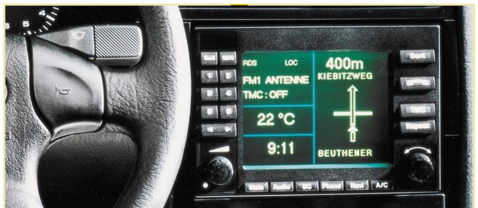
**Bild 5:** Die komplexe Integration verschiedener Kommunikations- und Bedienungskomponenten in einem zentralen und ergonomischen System erlaubt der Siemens-Vorschlag eines Fahrerinformationssystems. Foto: Siemens
