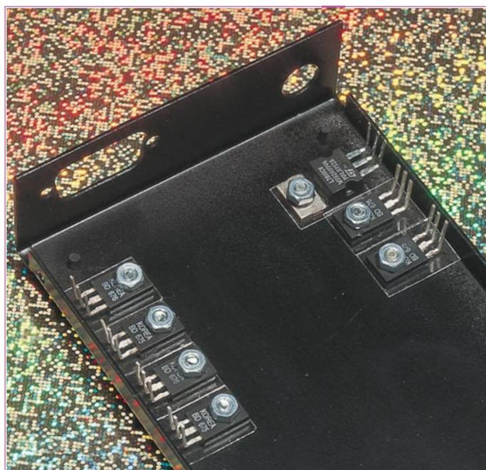
**Bild 3: Ansicht des Gehäuseunterteils mit montierten Transistoren und Spannungsregler**
