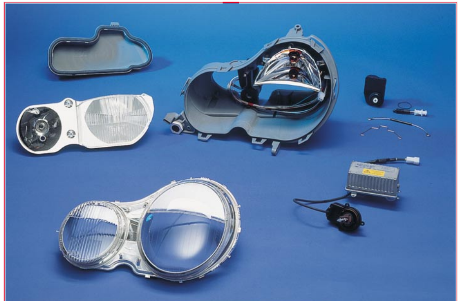
Bild 5: Die Bestandteile des Xenon-Scheinwerfers der Mercedes-Benz E-Klasse. Man erkennt deutlich die erstmalig auswechselbare und nahezu völlig glatte Scheinwerferabschlußscheibe aus Kunststoff. Foto: Mercedes-Benz.
