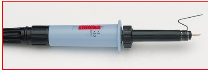
Bild 63: Tastkopf-Massefeder zur Verringerung der Masseanschluß-Induktivität
